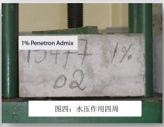
在暴露于 101.5psi(231.4 水头压力)四周之后,澎内传结晶反应完全抵御了水分渗透并且修复内部渗漏缺陷。
