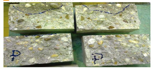
照片中可以看到用澎内传混凝土防水添加剂处理的试块(标注 P)和两个未经处理的对照试块。所有试块暴露于 72.5psi 水压中 72 小时后取出,将试块取出后劈开两半并测量水分渗透深度情况,立即拍摄以上照片。用澎内传处理的试块与未处理的试块相比水分渗透减少了 94.4%。
