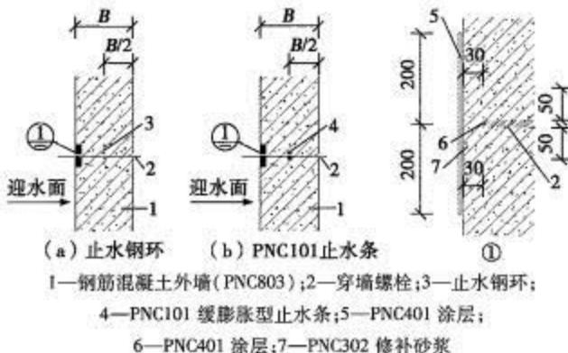
图 4.4.5 穿墙螺栓防水构造
