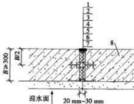
1—高模量密封膏密封;2—背衬材料;3—聚苯板填缝(上部);4—中埋式止水带;
