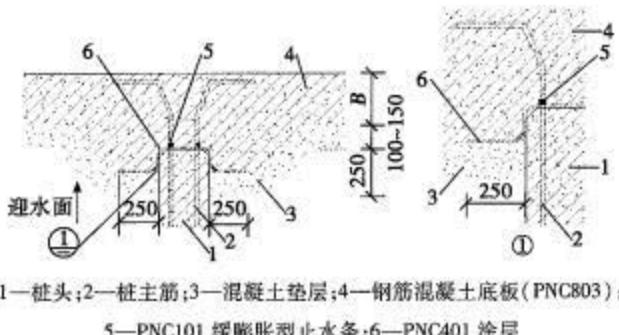
图 4.4.6 桩头防水构造
