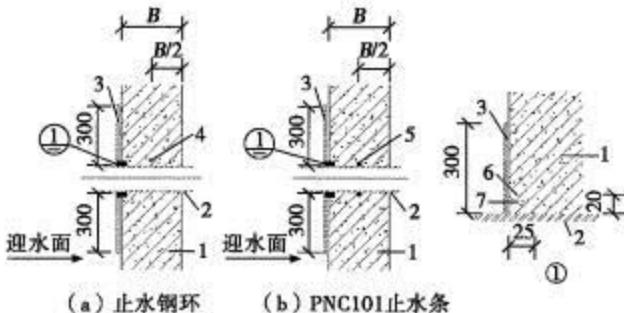
1—钢筋混凝土外墙(PNC803);2—穿墙钢管;3—PNC401涂层;4—止水钢环;
