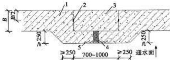
1—先浇钢筋混凝土(PNC803);2—PNC101缓膨胀型止水条;
