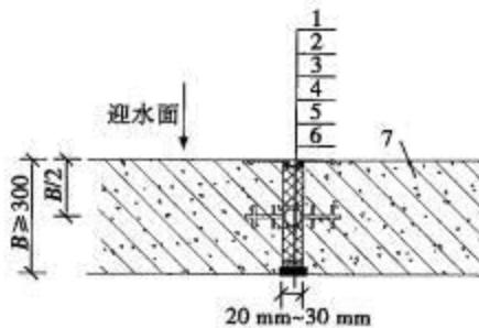
1—外贴式止水带;2—聚苯板填缝(内侧);3—中埋式止水带;4—聚苯板填缝(外侧);
