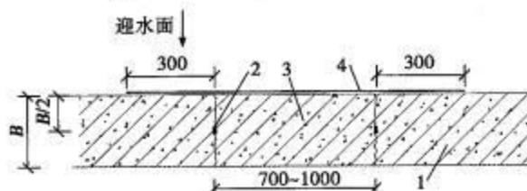
1—先浇钢筋混凝土(PNC803);2—PNC101缓膨胀型止水条;
